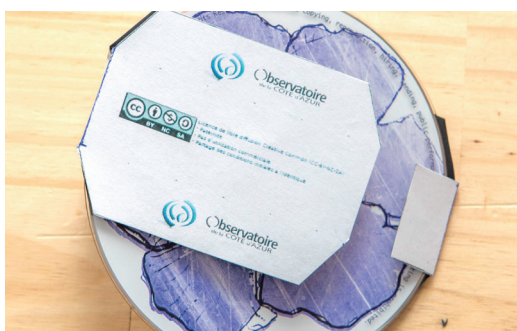
7 - Glisser le CD (DVD ou Blu-Ray) en dessous, face gravée vers le haut. Mettre un morceau de scotch pour maintenir le CD.
